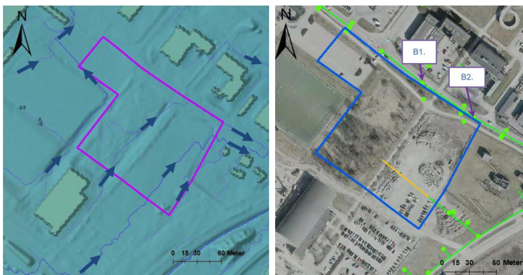
Figur 6. Till vänster visar blå pilar rinnvägar inom planområdet vid större regn, till höger framgår befintliga dagvattenledningar (gröna) och anslutningspunkter (B1 och B2). (Källa: Köpings kommun, Tyréns 2020)
