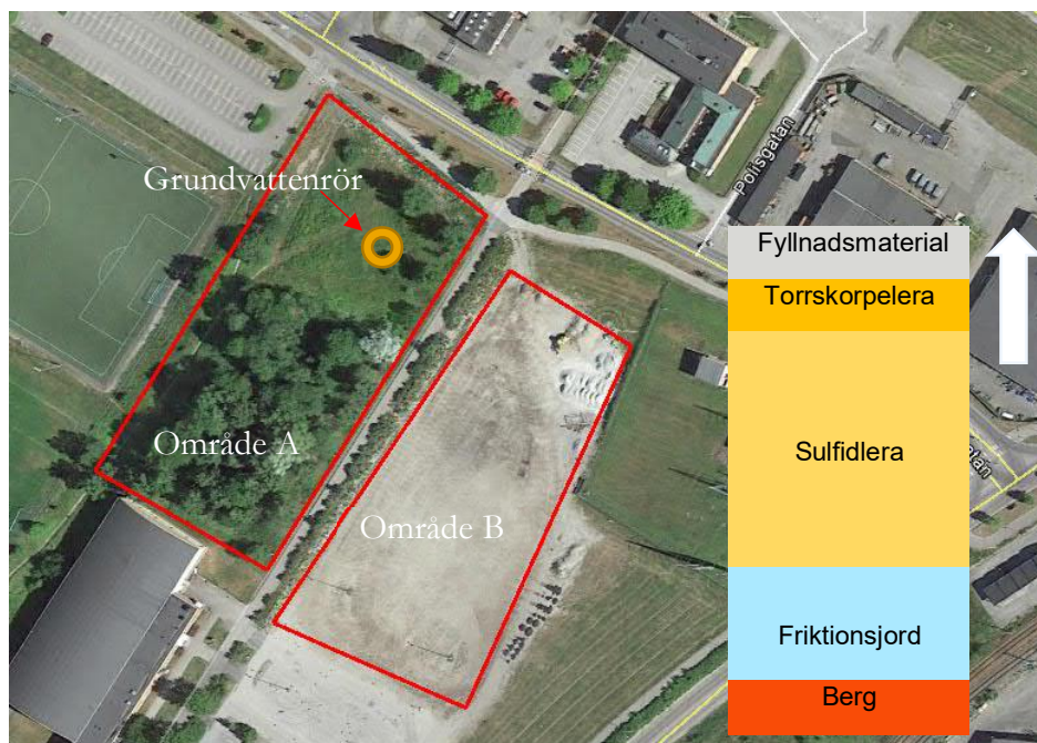
Figur 4. Områden där de geotekniska förhållandena undersökts, samt principskiss över dimensionerande jordlagerföljd. Källa: WSP.
